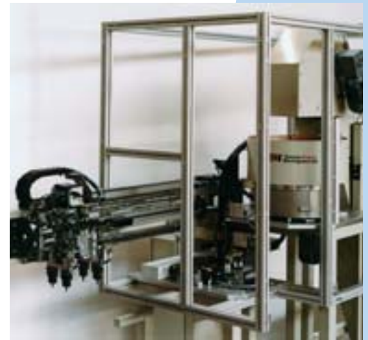
4-fach-Beladestation mit automatisierter Werkstück-Zuführung und Bereitstellung.
